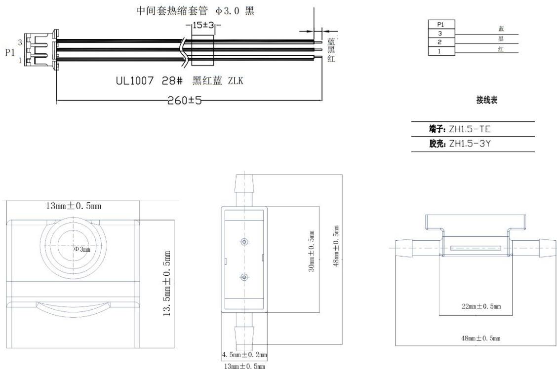
备注: 连接的线材可以根据需要做定制, 线序可以实际应用产品做特定的排序。
